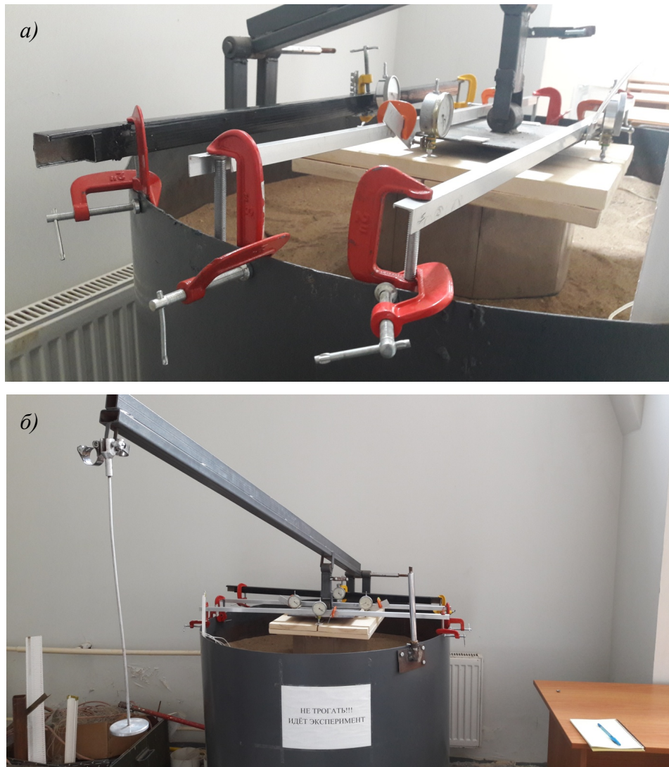
Рисунок 7.2.9 – Общий вид собранной экспериментальной установки а – система креплений датчиков перемещений; б – общий вид установки до загрузки
