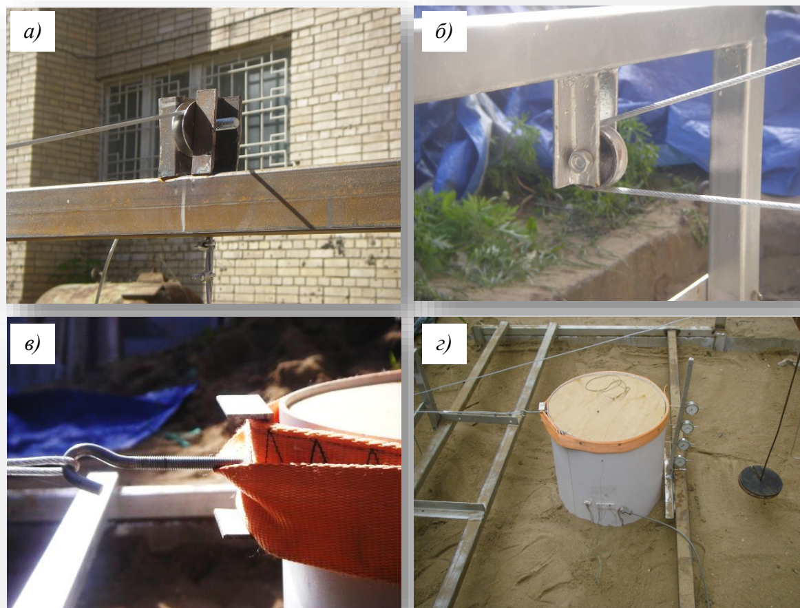
Рисунок 4.2.4 – Элементы установки. а, б – шарнирные блоки; в – устройство передачи нагрузки на оголовок; г – смонтированная установки
